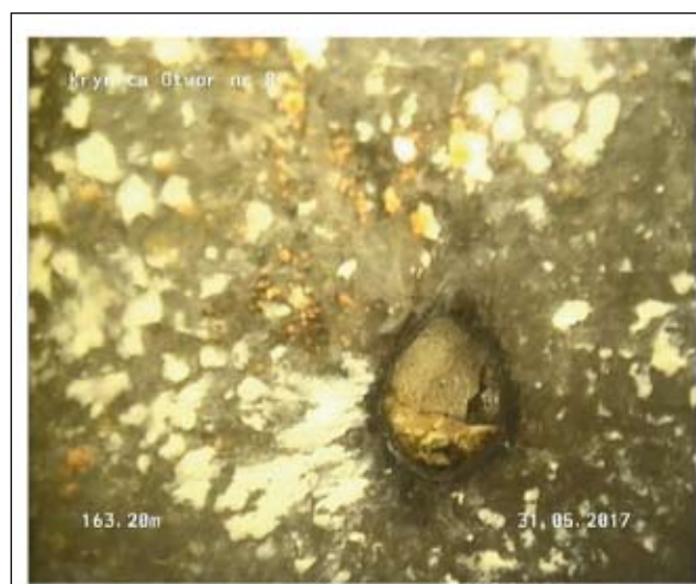
Fot. 1. Kadr z inspekcji TV – widok na otwór w obrębie rur okładzinowych na głęb. 163,2 m
